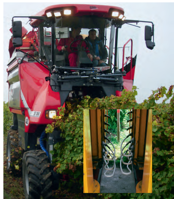
Abb. 3: Vollernter bei der Lese. Vor Reifebeginn erfolgte eine «Bandausdünnung» mit nur drei aktiven Schlägerpaaren.
