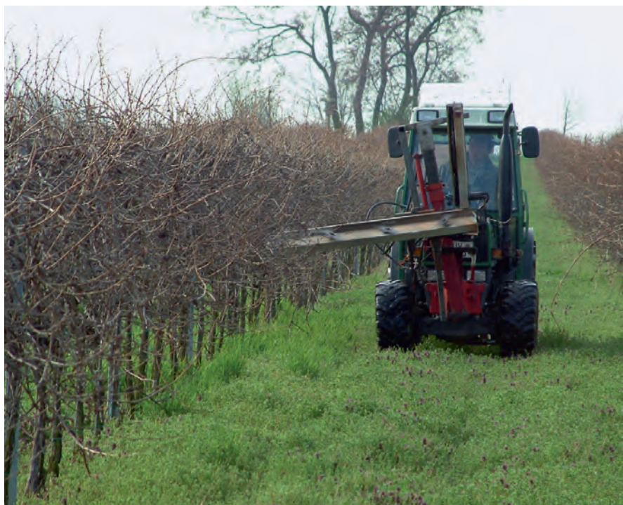
Abb. 1: (Minimaler) Winterschnitt. Hier mit umpositioniertem Laubschneider.
